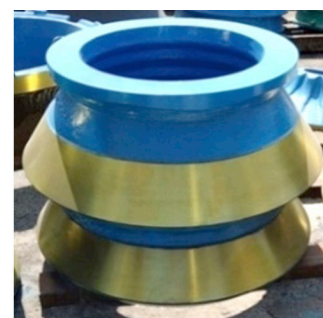
Футеровка дробильной установки
