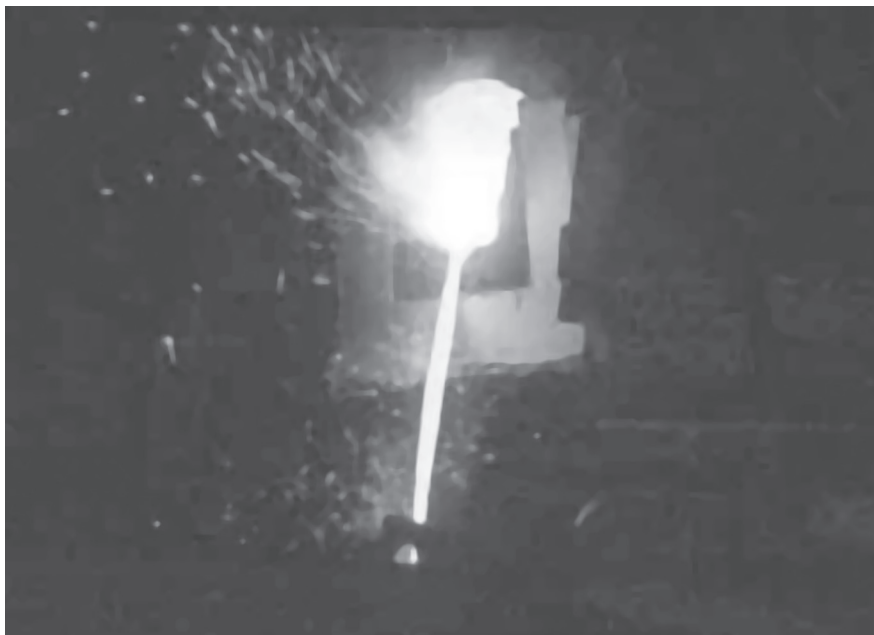
Рис. 2. Стационарный выпуск металла из печи Ромелт
