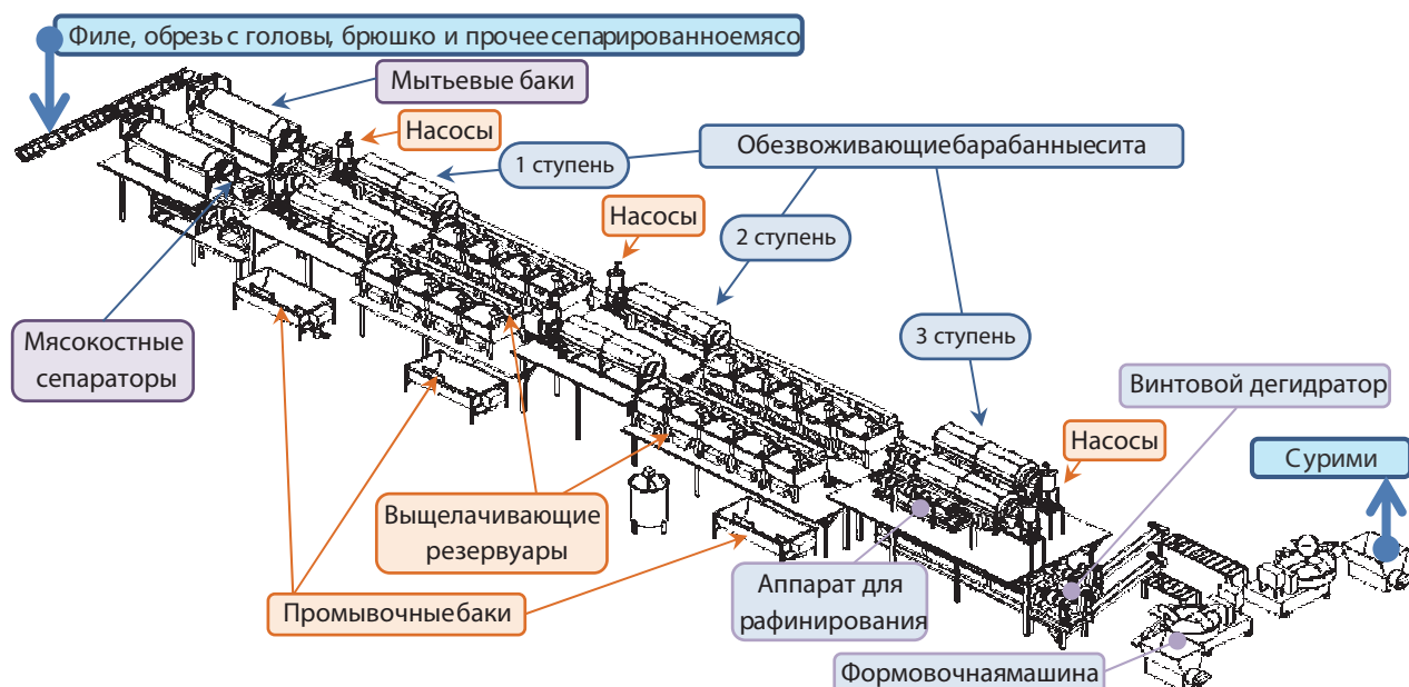
Рис. 2. Схема расположения оборудования по производству сурими по традиционной технологии
