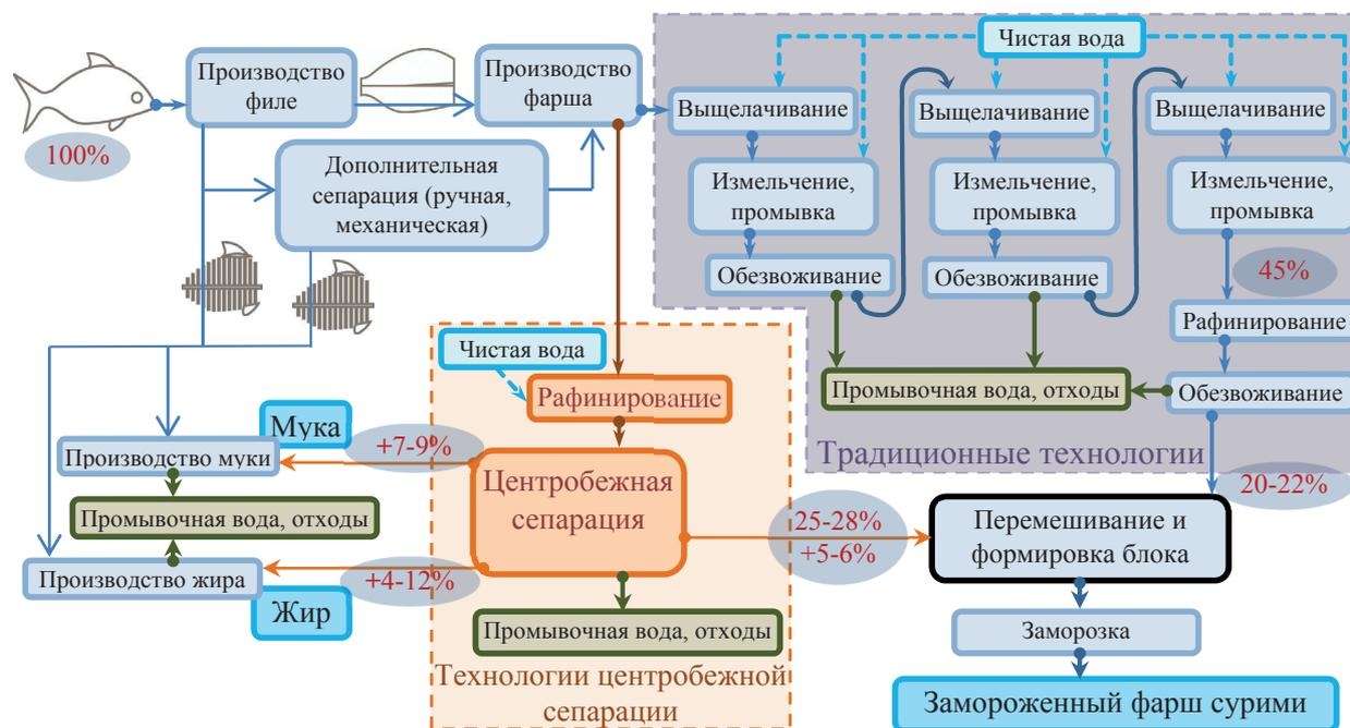
Рис. 3. Сравнительная схема технологических процессов производства сурими
