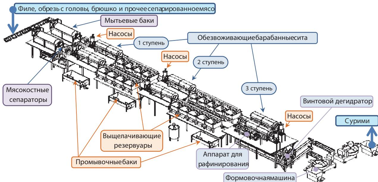
Рис. 2. Схема расположения оборудования по производству сурими по традиционной технологии
