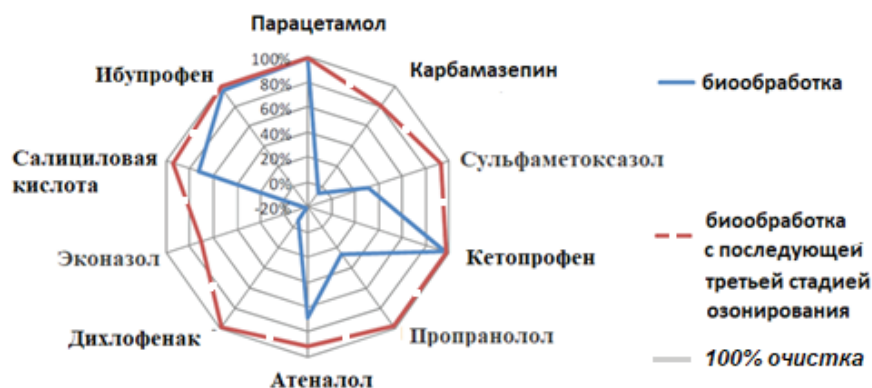
Рис. 3. Сравнение эффективности устранения фармакологических загрязнений при биологической очистке и в сочетании с озонированием [Comparison of pharmacological contamination elimination efficiency for biological water treatment and its combination with ozonation]
