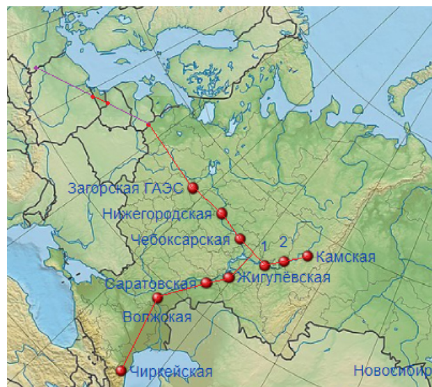
Рис. 2. Предполагаемая общая водородная энергетическая система ГЭС европейской части России
