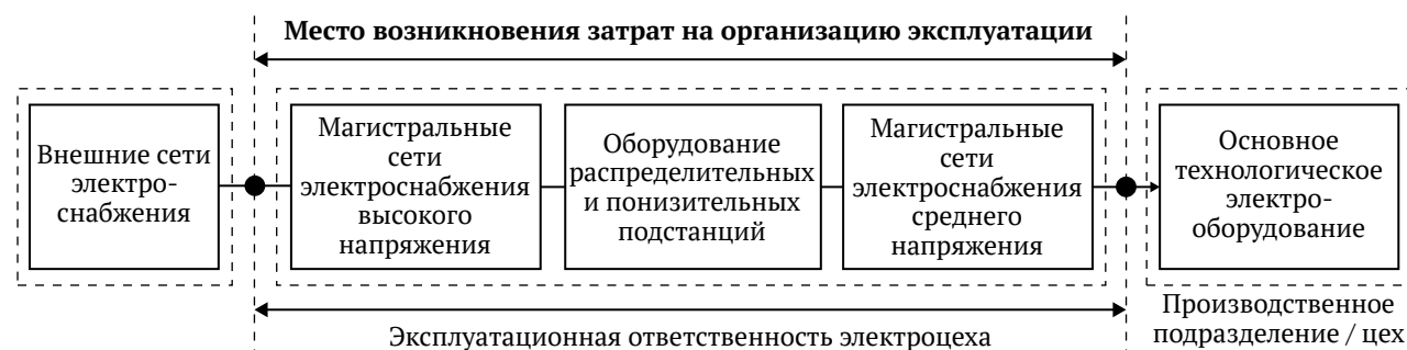
Рис. 2. Место возникновения затрат на реализацию функционала электроцеха в структуре промышленного предприятия
